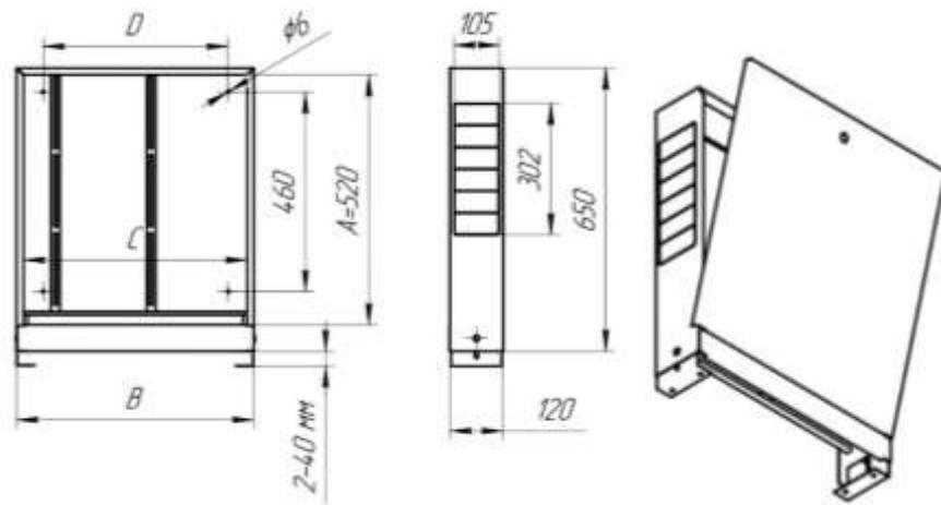
Рис. 1. Шкаф распределительный коллекторный ШРН «Балтика»
